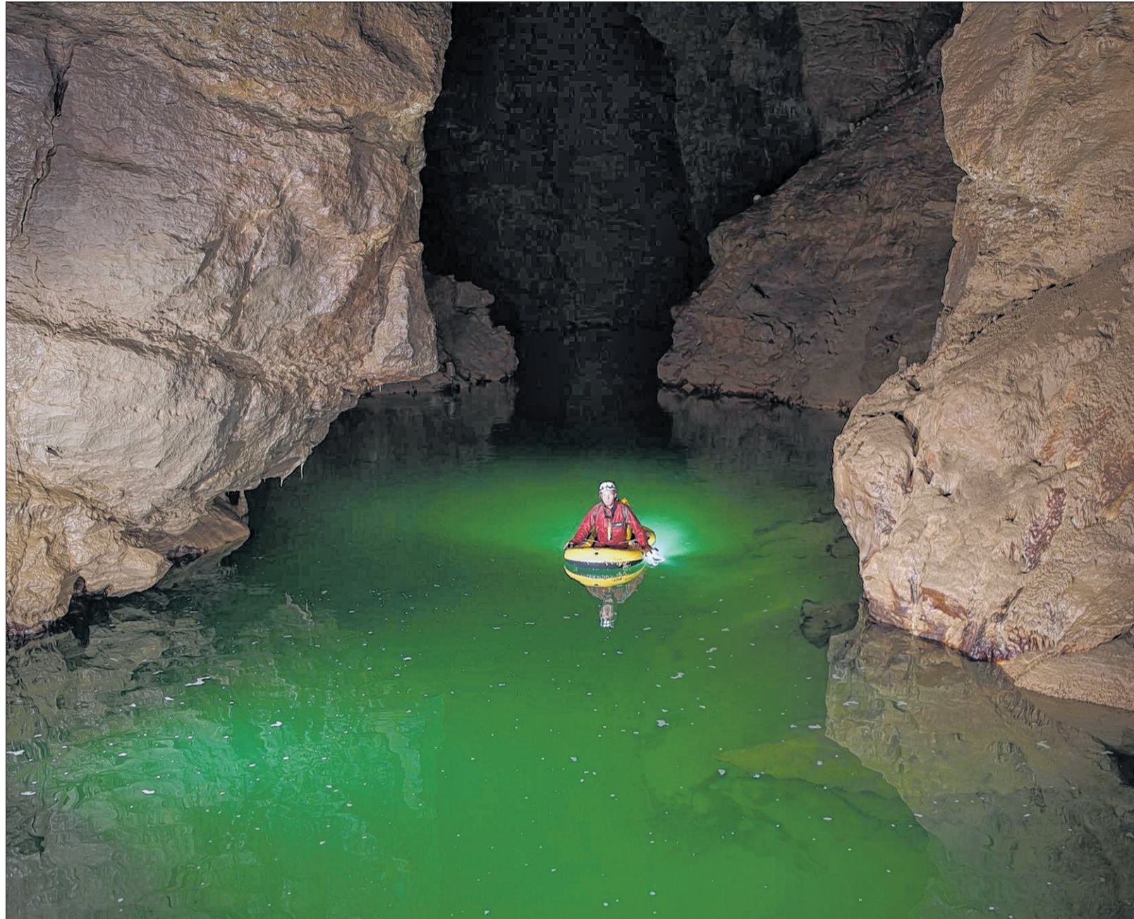
Grün leuchtet das Wasser des Mörikedoms: Uranin, das im Rahmen eines Markierungsversuchs in Laichingen ausgeschüttet worden war, kam im Blaubeurer Blauhöhle-System an. Forscher der „Arge Blautopf“ ziehen Wasserproben. Foto: Andreas Kücha
